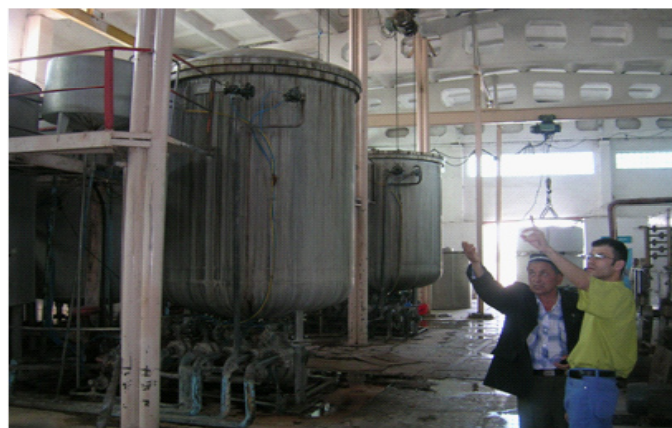
Хоразм вилоятининг пахта тозалаш заводларидан бирида гигроскопик пахта ишлаб чиқариш учун мўлжалланган сув цистерналари
