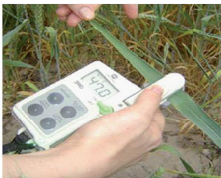
Кузги бўғдойнинг бошоқлаш даврида хлорофиллметрда ўлчов бажариш.
